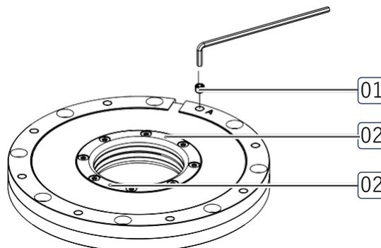
▶ 圧力安全弁の圧力設定と機能を確認してください。
