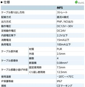
● リニアクランパ・ズィー RBPS LKPS LBPS ( → P.xxxx ) と組み合わせて使用するマグネットセンサ。RBPS LKPS LBPS のクランプ・アンクランプ状態をLEDの点灯状態で 表示します。
