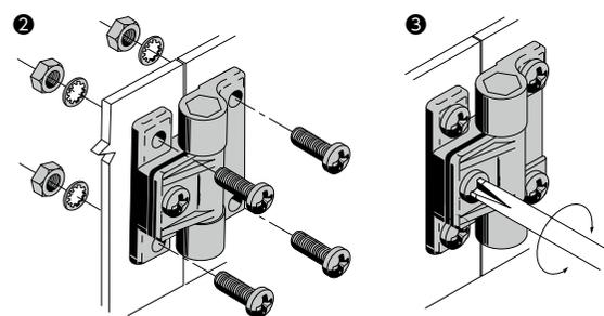
ねじの締め具合で、ドアの保持トルクを調整してください。
