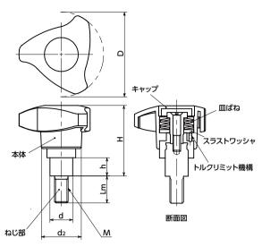
● トルクリミット機構を内蔵したノブ。締めつけトルクの管理が できます。
