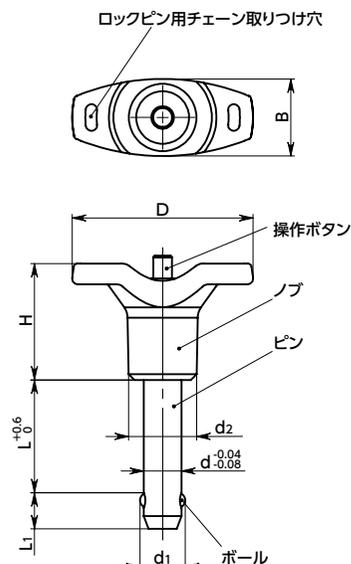
● **PWBLS-H** は **PWBLS** と区別するため、ピン先端に溝加工を施しています。
